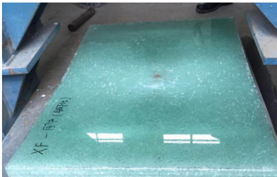
图 9 玻璃落锤实验图
