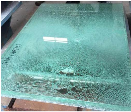
图 8 玻璃落锤实验图
